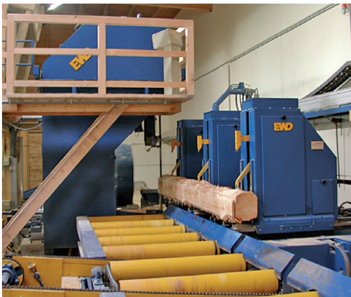
1600er-Blockbandsäge von EWD ist bereits seit 2006 im Einsatz – Spannböcke können einzeln verstellt werden
