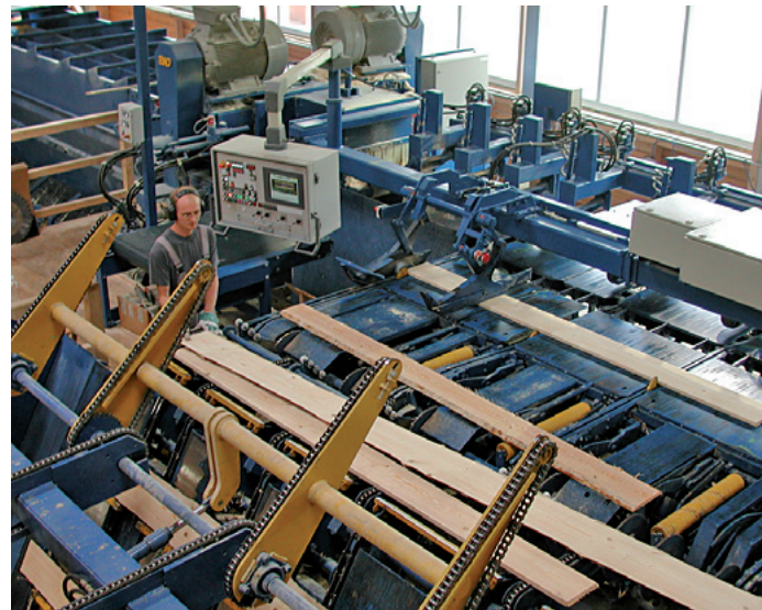
Durch die Besäum- und Nachschnittkreissäge können die Stämme flexibel aufgetrennt werden
